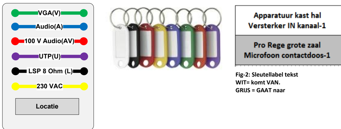
Fig-1: Kabel codering
